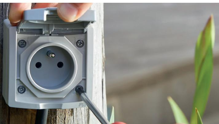
Gamme étanche d'usage général. Installation en saillie pour intérieur et extérieur. Indice d'étanchéité IP54 et IP44 pour la prise afin de résister aux aléas des conditions climatiques. Entrées de câble en diamètre max 20mm. Membranes flexibles. 7 commandes d'éclairage et prises disponibles, en connexion à vis
